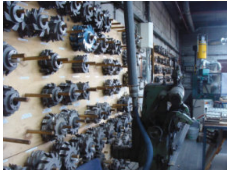
De slijperij met een wandrek voor frezen voor de schaafmachines; hier worden alle machineonderdelen geslepen en voorbereid voor orders.
