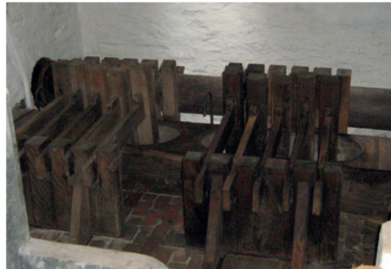
Hamberbakken met nokkenas van een papiergetijdemolen en een papierpers. Collectie Nederlands Openluchtmuseum, Arnhem.
